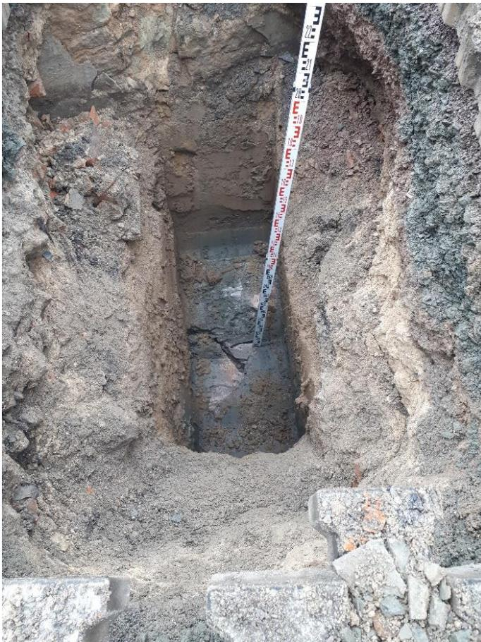
**Abb. 1:** Blick in den Schurf 2, etwa in der Südostecke des geplanten Gebäudes. Im oberen Schurfabschnitt ist unter dem Verbundpflaster und dem Schotteraufbau eine Auffüllung mit Bauschutt zu erkennen. Der Bauschutt wurde wahrscheinlich in ein ehemaliges Untergeschoss verfüllt, denn an der linken Schurfwand steht noch ein Teil des früheren Betonfußbodens hervor. Darunter Verwitterungslehme und an der Basis graue und rötlich gefärbte Sandsteine mit dunkelgrauen Silt-Tonsteinlagen dazwischen.
