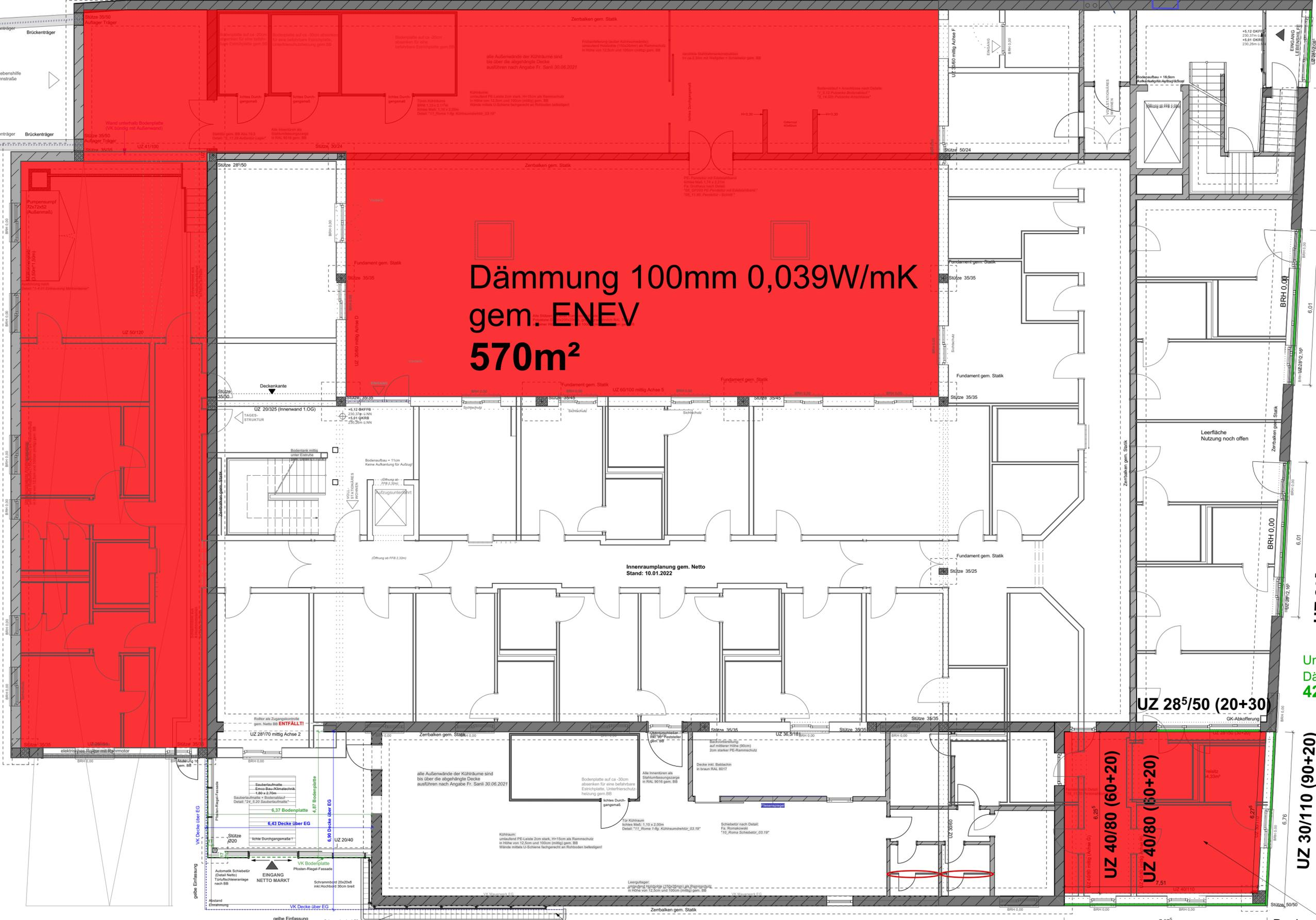
**Dämmung 100mm 0,039W/mK
